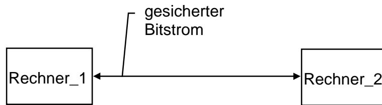
Bild 2-13 Gesicherter Bitstrom zwischen benachbarten Rechnern. Rechner 1 sei etwa eine DEE, Rechner 2 eine DÜE
